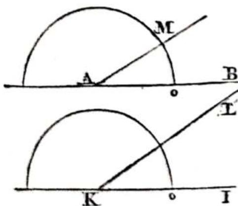
Dispongasi l'istrumento in modo che il suo centro sia in K, e che il diametro coincida con KI, e si esamini a quale divisione del suo lembo corrisponde il lato KL. supponiamo che sia la 39.<sup>a</sup>
